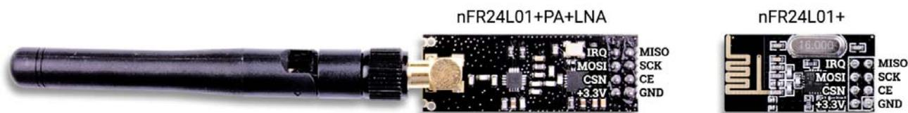
Для подключения модуля nRF24L01 к Arduino, можно воспользоваться адаптером в котором имеется собственный стабилизатор напряжения 3,3 В, а так же подписанная однорядная колодка выводов, позволяющая подключить модуль к Arduino используя однорядный шлейф. Адаптер подключается к напряжению питания 5 В постоянного тока.
