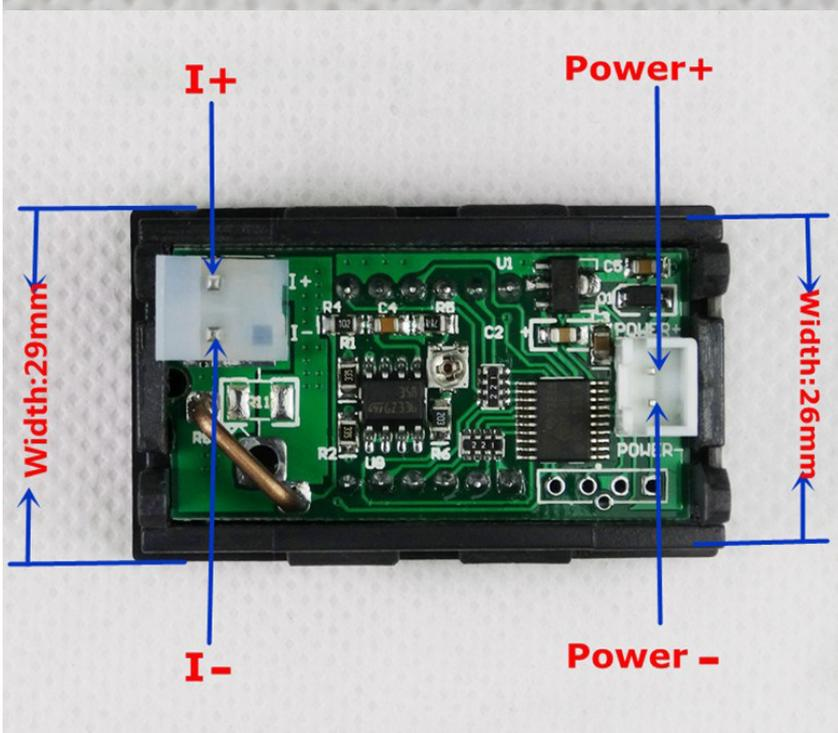
Схема подключения прибора при использовании отдельного источника питания:
