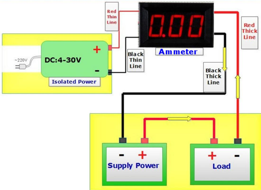
Схема подключения прибора при питании от измеряемой схемы:
